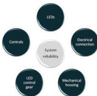
Ryc. 1: Trwałość oprawy zależy od trwałości układu
